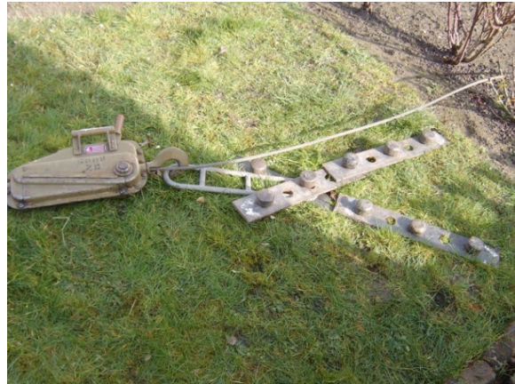
„Hauptgruppe als V-Formation nach dem Eintreiben der Erdnägel mit Greifzug“
