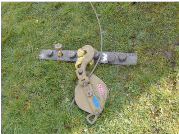
„Vorgruppe mit Klappkloben als Umlenkrolle und Greifzugseil“
