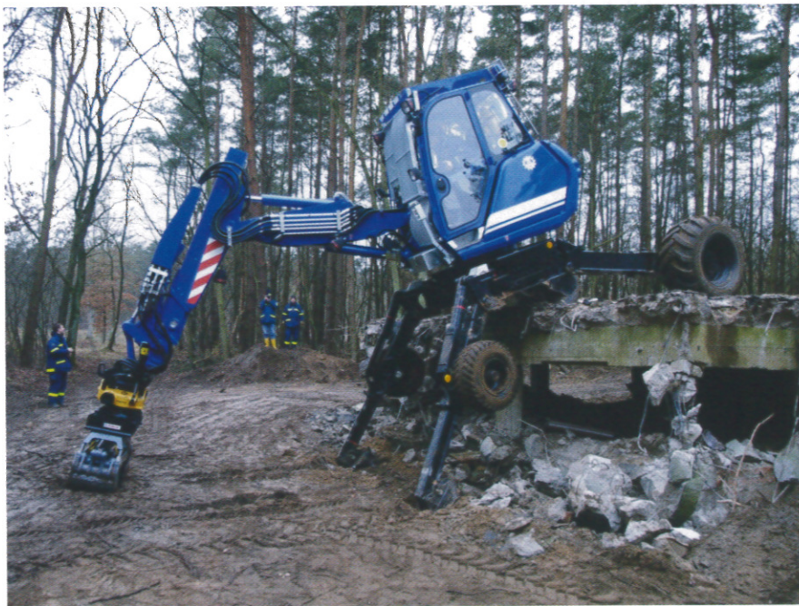
Die Rettungsspinne beim Marsch über Trümmer (Hindernishöhe 1,80 m, angesprengte Betondecke)
